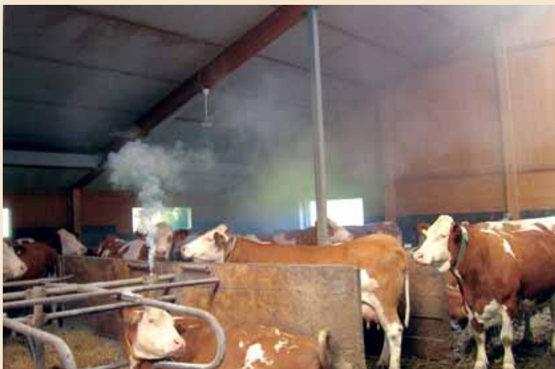
Bild 2: Ohne Deckenventilatoren ist eine gleichmäßige Belüftung aller Stallbereiche schwierig, wie das Experiment mit der Rauchkerze zeigt.
