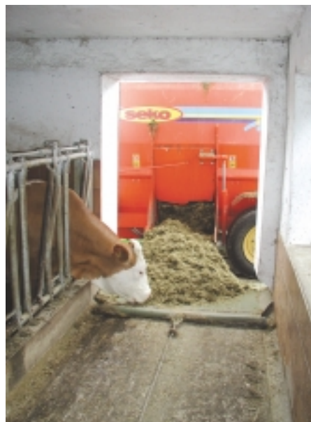
Platzsparende Futtervorlage. Der Futtermischwagen vor der Stalltüre belädt ein Futterband, welches das Frischgut zu den Kühen transportiert. Die Kühe fressen direkt vom Band (entwickelt von Fa. Eder-Landtechnik/Tuntenhausen). Fotos: Firma Eder
